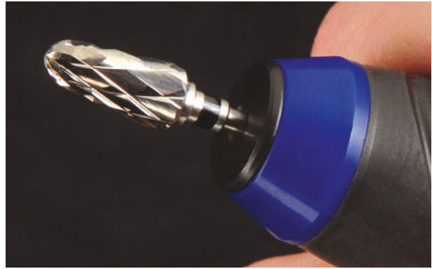
Richtige Einspanntiefe. Correct insertion depth. Montage correct.
